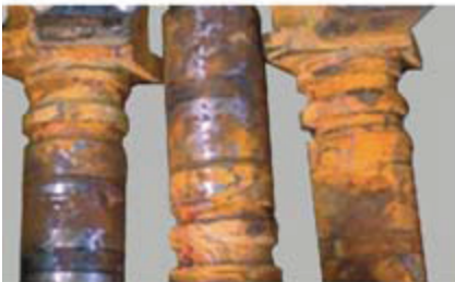
Unit Pump Coroziune puternică
