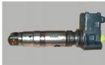
Unit Pump Deteriorări mecanice
