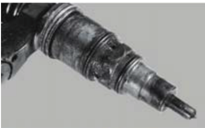
Unit Injector Coroziune puternică
