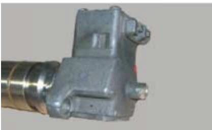
Unit Pump Conectorul de înaltă presiune este deteriorat
