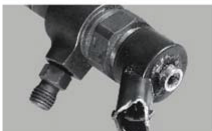
Deteriorări ale conectorilor electrici
