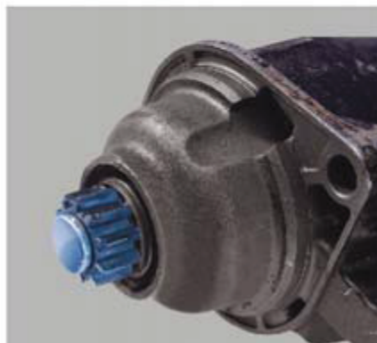
Axul este colorat în albastru ca urmare a supraîncălzirii
