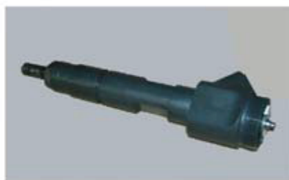
Injectorul este incomplet
