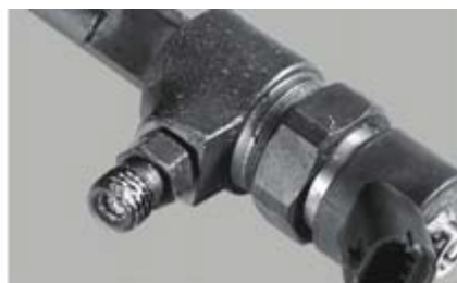
Deteriorări ale carcasei sau filetului.
